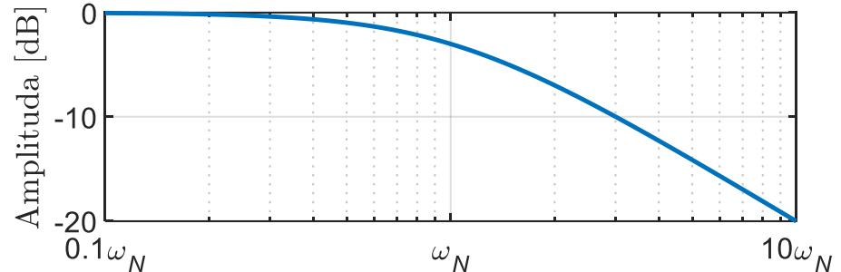
Na slici desno je prikazana amplitudska karakteristika ovog filtra. Strmija karakteristika se može postići povećavanjem reda filtra, ali na račun izobličenja amplitudske karak. na nižim učestanostima.
