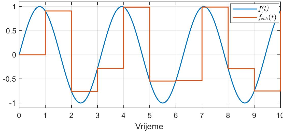
Jasno je da se tačnost rekonstrukcije povećava sa smanjenjem periode odabiranja  $T$  ( $T=1s$  u ovom primjeru). Tačnost ZOH metode se može analizirati i u frekvencijskom domenu. Najprije treba odrediti impulsni odziv ZOH kola, na osnovu kojeg dalje određuje njegova funkcija prenosa i crta frekvencijska karakteristika.
